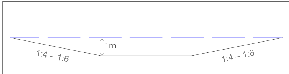
Figur 17. Föreslagen sektion för torr damm/översvämningssyta. Slänterna har lutning 1:4–1:6 och när dammen är vattenfylld är vattendjupet maximalt 1 m.
